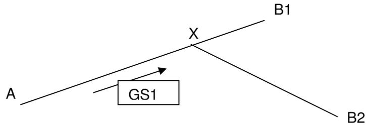
Determino prima il tempo necessario a percorrere A-B1  $t = m/GS1$  con m distanza
