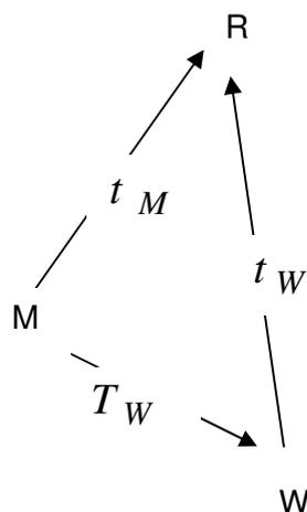
Dove M=Master, W = Slave, R posizione ricetrasm. (A/M), MW Linea Base,  $t$  e  $T$  i tempi necessari alle onde per percorrere i relativi tratti, e  $\delta$  il Delay Time. Vale :
